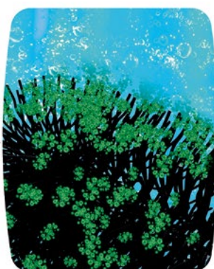
Dalszy rozkład zanieczyszczeń poprzez błonę biologiczną natlenionego złoża utwardzonego
